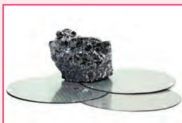
Échantillon de silicium polycristallin et galette de silicium.
